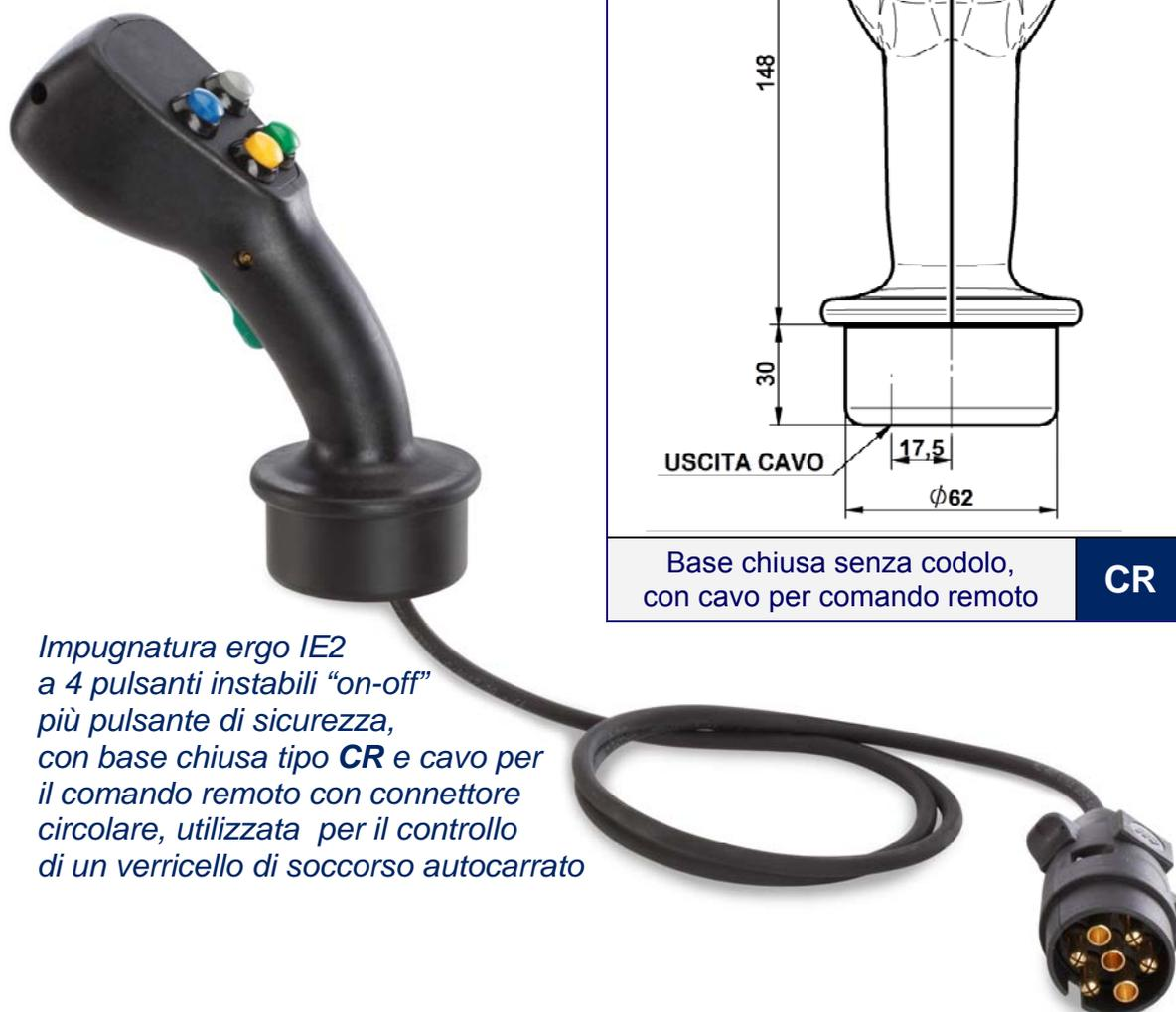
*Impugnatura ergo IE2 a 4 pulsanti instabili "on-off" più pulsante di sicurezza, con base chiusa tipo **CR** e cavo per il comando remoto con connettore circolare, utilizzata per il controllo di un verricello di soccorso autocarrato*
