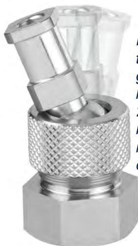
*Il codolo a giunto sferico tipo **GS** consente di regolare l'inclinazione dell'impugnatura da 0° fino a 20° in ogni direzione e di bloccarla, tramite la ghiera, nella posizione più confortevole per l'operatore*
