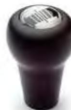
Le configurazioni con pulsante elettrico sono allestite con pulsanti "off-on" a prova di polvere, con portata massima di 5 A resistivi (3 A induttivi), tensione massima di 28 VDC, 2 o 4 pin e classe di isolamento IP64 standard e IP68 a richiesta. I pulsanti sono azionati tramite cappucci rigidi di facile sostituzione dall'esterno e disponibili in una gamma di 9 differenti colori e in 2 tipi di altezze.
